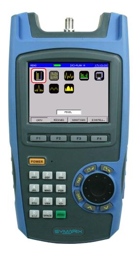
Das DS2500C misst eine umfassende Reihe von digitalen Signalparametern (Kanalleistung, MER, BER, Konstellationsdiagramm) sowie analoge Signal-Eigenschaften (Pegel, HUM, C/N, Modulationsrate), und Spektrumanalyze. Zur Messung von Einstrahlungen (Ingress) bietet das Gerät eine Spektrum-Peak-Hold Funktion.
